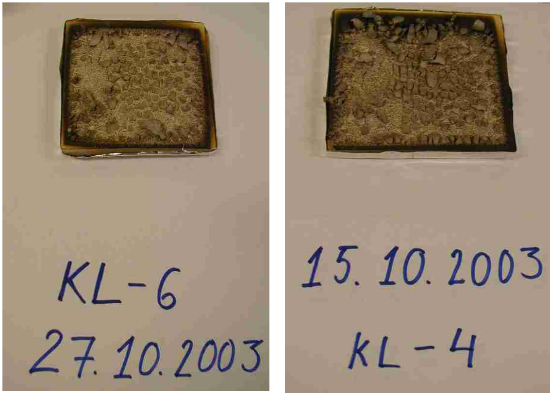
Kuva B5. Kipsilevynäytteitä valokuvattuina kartiokalorimetrikokeen jälkeen. Vasemalla näyte KL-6 (vaakasuora asento kokeessa), oikealla näyte KL-4 (pystysuora asento kokeessa). Näytteiden pinnassa näkyvä hilseily on päällystekartongista jääneitä palamisjätteitä. Kummassakin kokeessa käytettiin säteilytystehoja 25 kW/m 2 .
