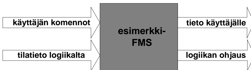
Kuva 28. Esimerkkijärjestelmän tulot ja lähdöt.
