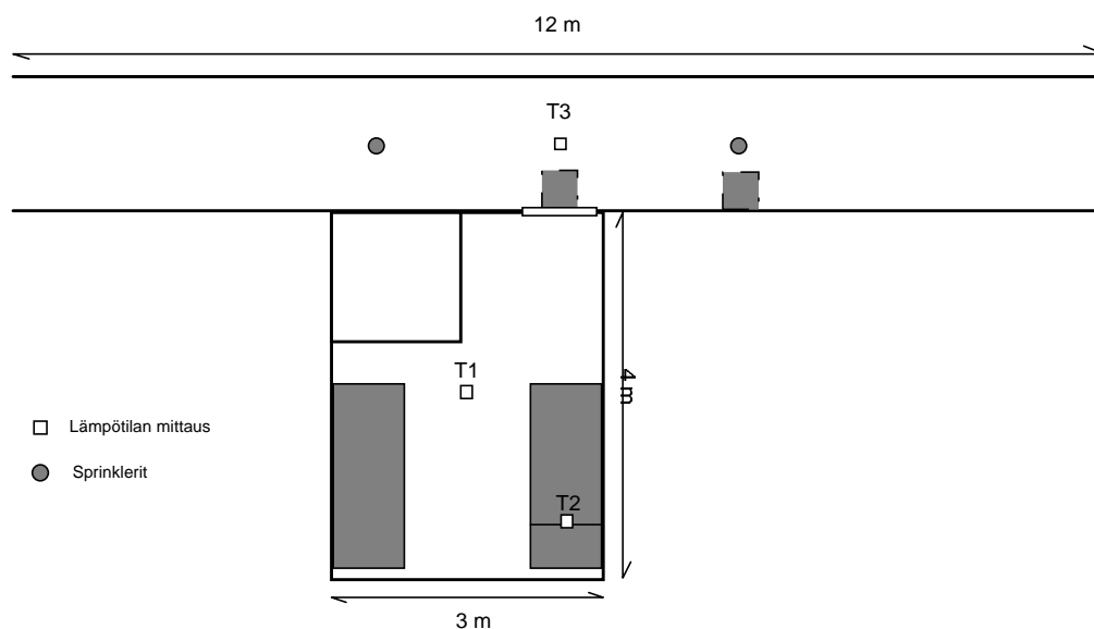
Kuva 1. Hytti ja käytävä. Kuvaan on merkitty hytin kerrossänkyjen paikat, käytävässä sytytettävän patjapinon vaihtoehtoiset sijoituskohdat sekä lämpötilan mittauskohdat.
