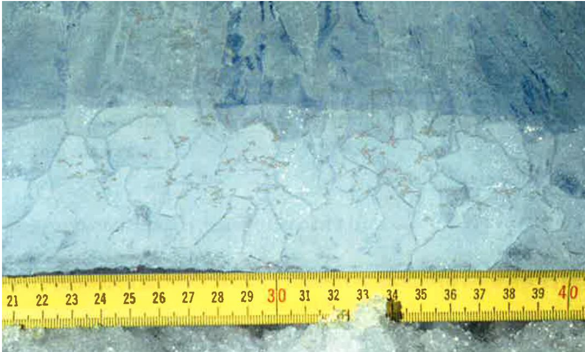
Kuva 3. Keväällä jää sulaa kiderajoilta ja kantavuus heikkenee nopeasti. Kuva teräsjästä, jonka kiderajat ovat selvästi näkyvissä.
