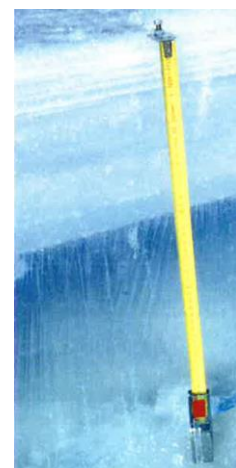
Kuva 1. Jäessä esiintyvät rakennekerrokset. Oikealla olevassa valokuvassa on ohuilla vesikerroksilla vahvistettua jäätä, jossa teräs- ja kohvajääkerrokset ovat tunnistettavissa jään väristä.
