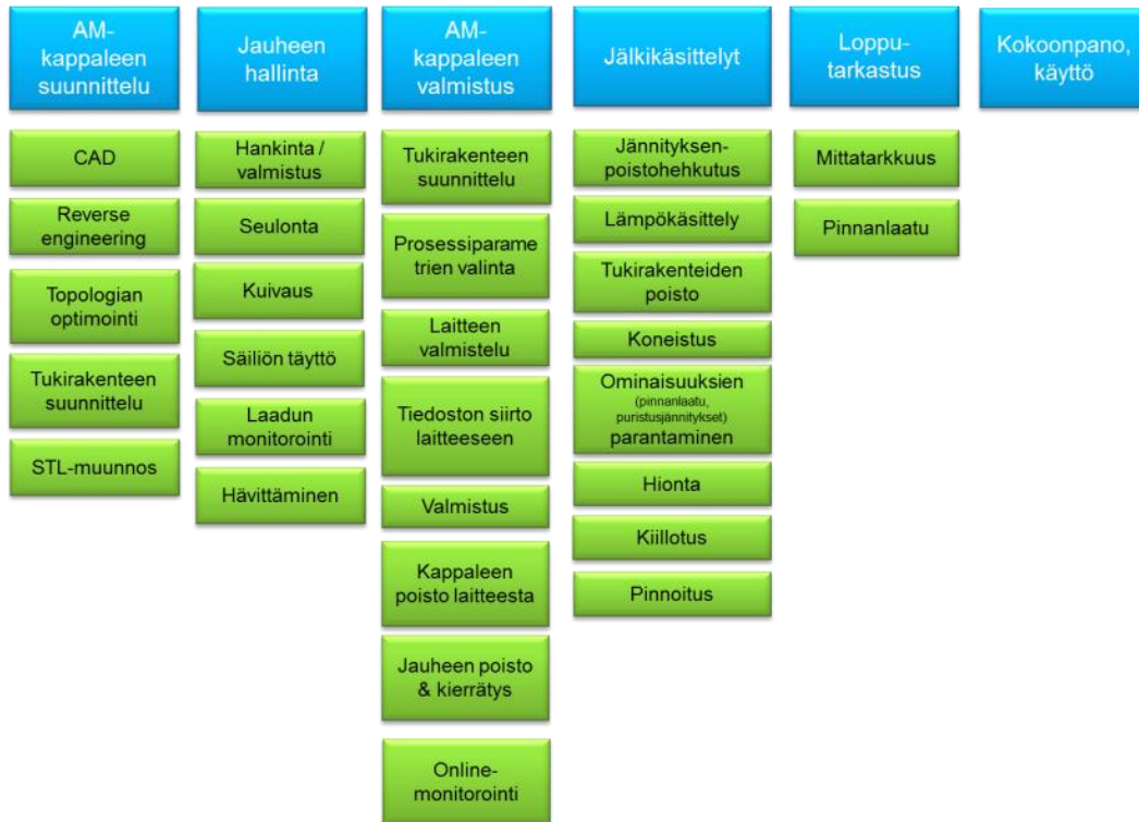
Kuva 1. AM-prosessin työvaiheet (metallien AM-valmistus jauhepetimenetelmällä).
