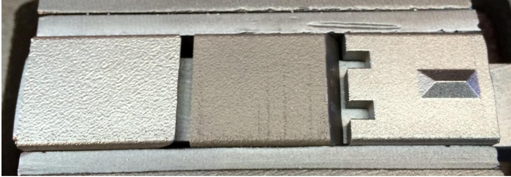
Kuva 3. Reunoilla keraamikuulilla puhalletut kappaleet (kirkkaammat) ja keskellä teräskuulilla puhallettu kappale (tummempi).
