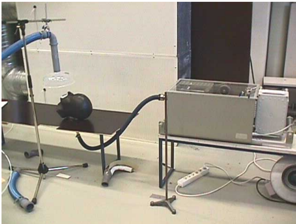
Kuva 7 Kohdepoiston tehokkuuden mittauksessa käytetty koejärjestely.
