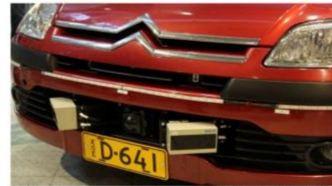
Ensimmäinen Suomen liikenteeseen päästetty robottihenkilöauto hyödyntää kaupallisia anturiratkaisuja. The first robotic vehicle on Finnish roads utilizes commercial sensor solutions.
