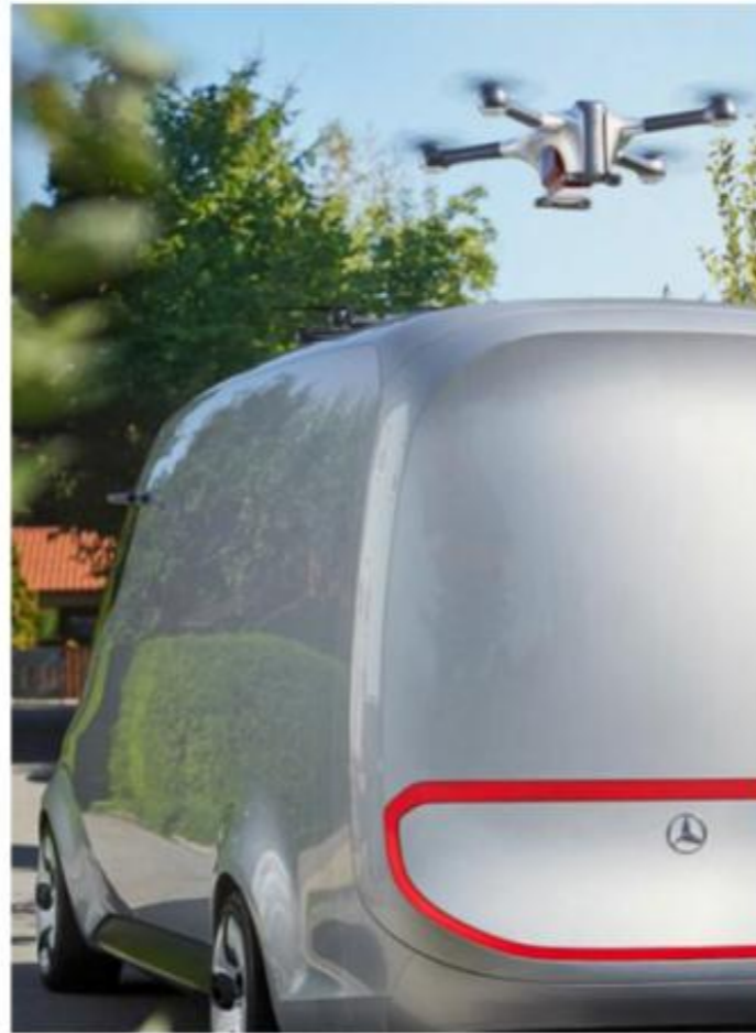
Daimler on tehnyt jakeluauton, jossa pakettien jakelu hoidetaan auton katolta lähtevällä robottinelikopterilla. Daimler has tested a delivery van with a quadcopter lifting off and landing from the roof.
