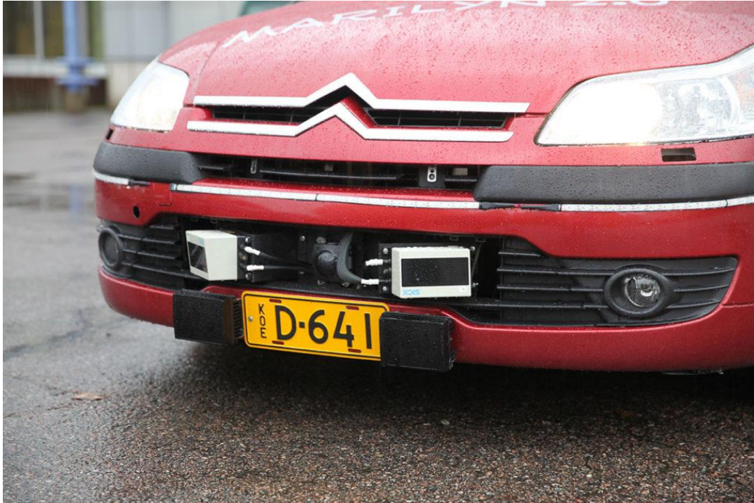
Marilyn skannaa ympäristöään tutkilla ja kameroilla. Esimerkiksi sijainnin määrittämisessä ei gps:n ja digitaalisen karttamateriaalin tarkkuus riitä, vaan paikkatietoa täsmennetään kaista- ja tiemerkeitä tulkitsemalla.
