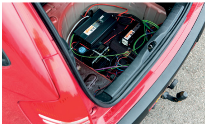
VTT:n testiauto Marilynin keula on lastattu antureilla ja peräkontti tietokoneilla.
