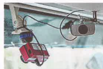
■ Ajoneuvoyhdistelmään on asennettu muun muassa kameroita, tutkia ja muita sensoreita, joilla tutkitaan digitalisaation mahdollisuuksia autoilun turvallisuuden parantamiseksi.
