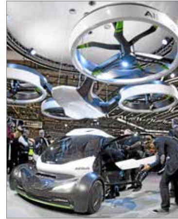
Lentokonevalmistaja Airbusin mukaan sen lentävässä konseptiajoneuvossa yhdistyvät kaksipaikkaisen sähköauton ja pystysuoraan nousevan lentokoneen ominaisuudet.
