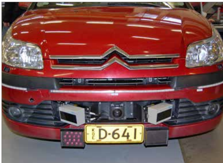
Citroënin keulaan on asennettu liikennettä havainnoivia tutkia ja antureita 50 000 euron arvosta. Tämä robottipilotti on kehitetty kaupunkiajoon.
