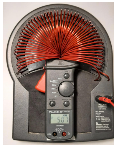
Kuva 2. Pihtivirtamittari 50 kierroksen kalibrointikelassa mittaa suurta 500 A tasavirtaa.
