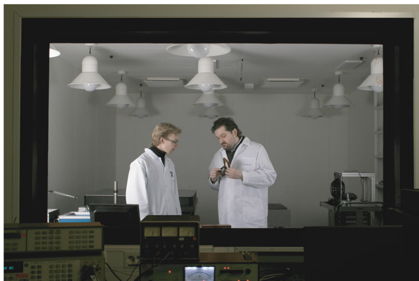
Kuva 1. Mikrofonien resiprookkikalibrointi alkamassa äänieristetyssä laboratoriossa.
