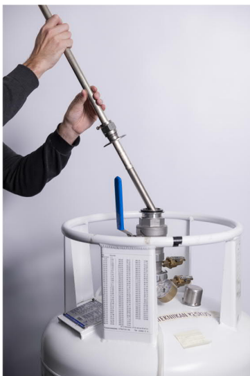
Kuva 1. Tasajännitteen jäljitettävyyden perustuu nesteheliumissa jäähdytettävään Josephson-normaaliiin.
