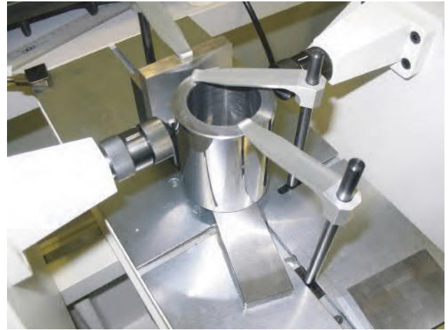
Kuva 2. Kappaleen ja referenssin kiinnitys vierekkäin vertailumittauksessa.
