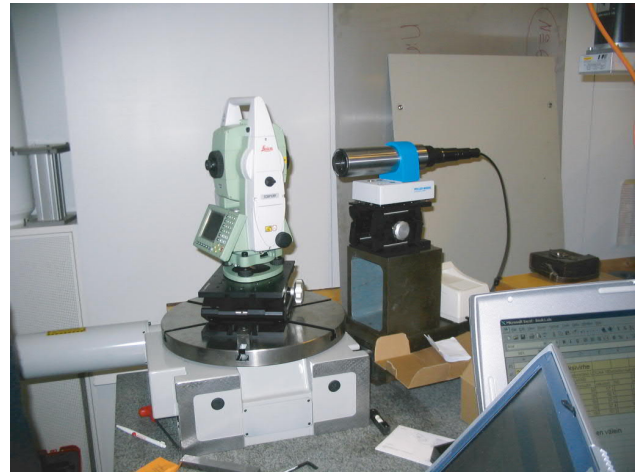
Kuva 2. Takymetrin vaaka-asteikon kalibrointi Eimeldingen pyöröpöydällä käyttäen tähtäyskohteena kollimaatioputkea.
