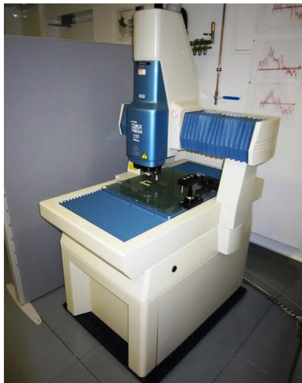
Kuva 2. VTT MIKESin videokoordinaattimittauskone.
