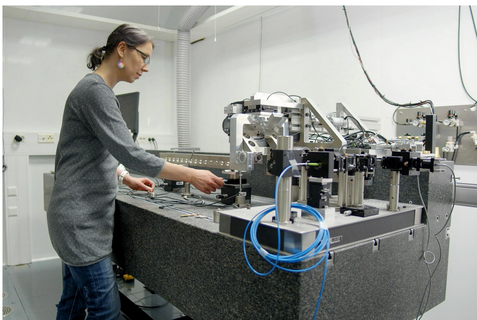
Kuva 1. VTT MIKESin interferometri porrasmittapalojen kalibrointiin.
