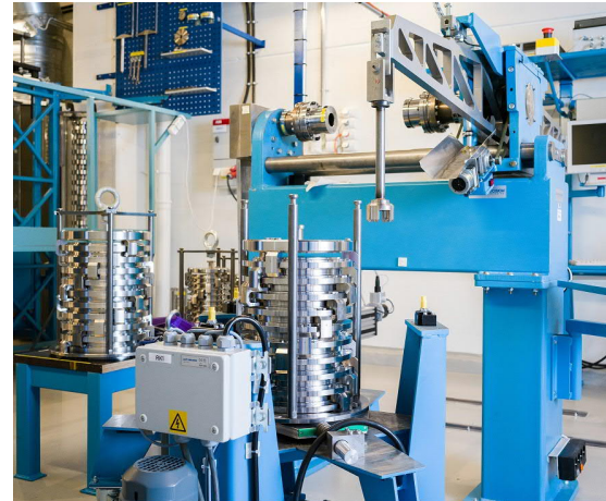
Kuva 2. Suorakuormitukseen perustuva vääntömomenttinormaali, 2 kNm.
