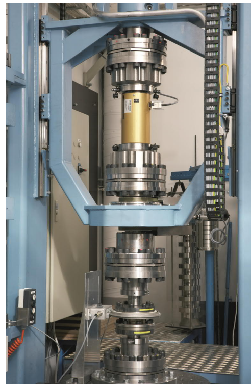
Kuva 3. Referenssianturiin perustuva vääntömomenttinormaali, 20 kNm.
