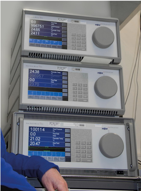
Kuva 1. Optisten kastepistemittarien kalibrointi.
