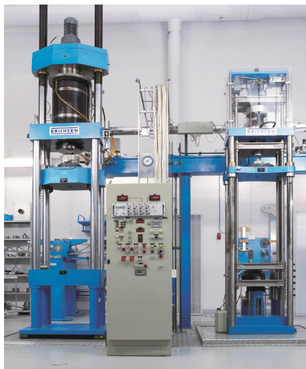
Kuva 1. Hydrauliseen vahvistukseen perustuva 1 MN:n voimanormaali sekä 100 kN:n suorakuormitteinen voimanormaali. Laitteiston kokonaiskorkeus on noin 8 m, mihin sisältyvät lattiatason alapuolella olevat kuormitusmassat.
